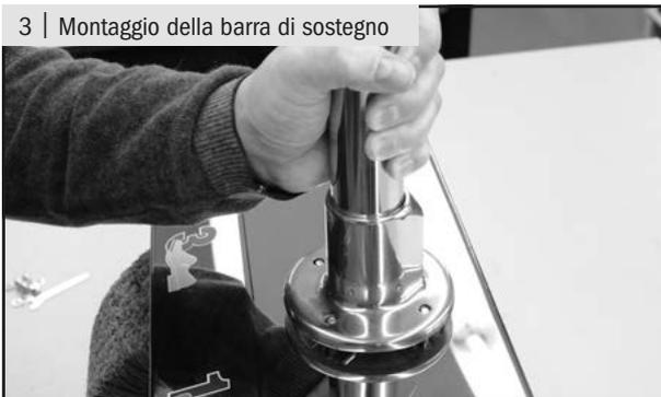
Girare la barra di sostegno così che le due viti senza testa sulla flangia inferiore della barra di sostegno sono rivolte verso la parte posteriore della macchina. Collocare la barra di sostegno nella giusta posizione sopra i 4 tiranti filettati. Prestare attenzione che durante il posizionamento non venga incastrato il cavo di alimentazione della barra di sostegno.
