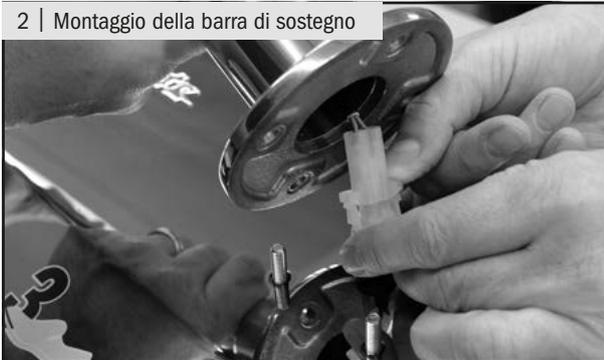
Per prima cosa, con l'apposita chiave, rimuovere i 4 dadi esagonali M6 e le rispettive rosette elastiche dall'alloggiamento della macchina lustrascarpe. Una persona mantiene la barra di sostegno in posizione verticale sopra la macchina lustrascarpe mentre l'altra collega il connettore della macchina lustrascarpe con quello della barra di sostegno. Prestare attenzione che le apposite alette raggiungano la posizione di blocco.
