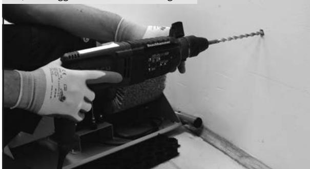
Dopo aver segnalato i punti di perforazione, posizionare la macchina lustrascarpe sul tappetino in gomma con l'aiuto di una seconda persona. Con un trapano elettrico adatto e una punta da muro ( $\varnothing$  10 mm) eseguire una perforazione dritta in ciascuno dei 4 punti precedentemente segnalati (vedi sopra) servendosi di una battuta d'arresto a 85 mm di profondità.
